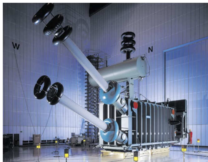
Figura 5.8-2: Transformador convertidor para transmisión bipolar HVDC sistema \pm 500 kVDC; 2500 MW; monofásico; 420 kVAC; 515 kVDC; 397 MVA; sistema de estrella (lado izquierdo de la figura) y sistema delta (lado derecho de la figura)
