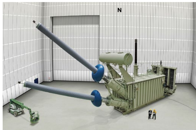
Figura 5.8-1: Transformador convertidor para transmisión bipolar UHVDC sistema \pm 800 kVDC, 6.400 MW; 2.071 km: monofásico; 550 kVCA, 816 kVCC; 321 MVA; alimentación del sistema de estrella de alto pulso
