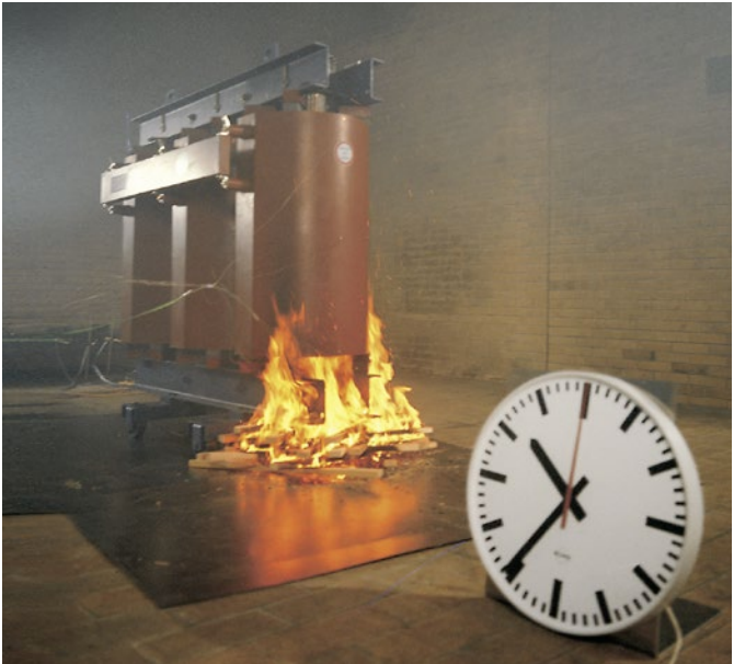
Figura 5.9-6: Ensayo de inflamabilidad del transformador de resina fundida
