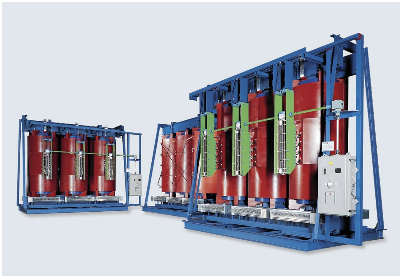
Figura 5.9-10: Transformador de resina colada GEAFOLE de 16/22-MVA con cambiador de tomas bajo carga exento de aceite
