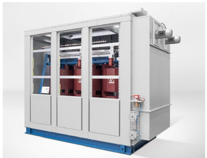
Figura 5.9-13: Transformadores de resina colada GEAFOLE en carcasa protectora con sistema de refrigeración aire-agua
